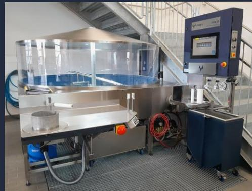
**Saugschlauch- und Armaturenprüfstände**
