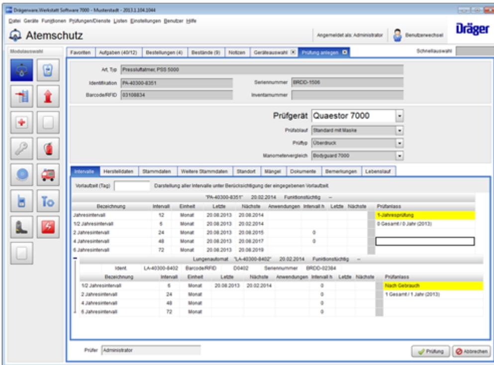
Wurden in der MAT-Hierarchie die Werte für den Prüfablauf und Prüftyp noch nicht vordefiniert, müssen an jedem Arbeitsplatz diese Werte vor der Prüfung festgelegt werden. Hierzu öffnet sich ein neues Fenster, in dem die Zuordnungen vorgenommen werden können.
