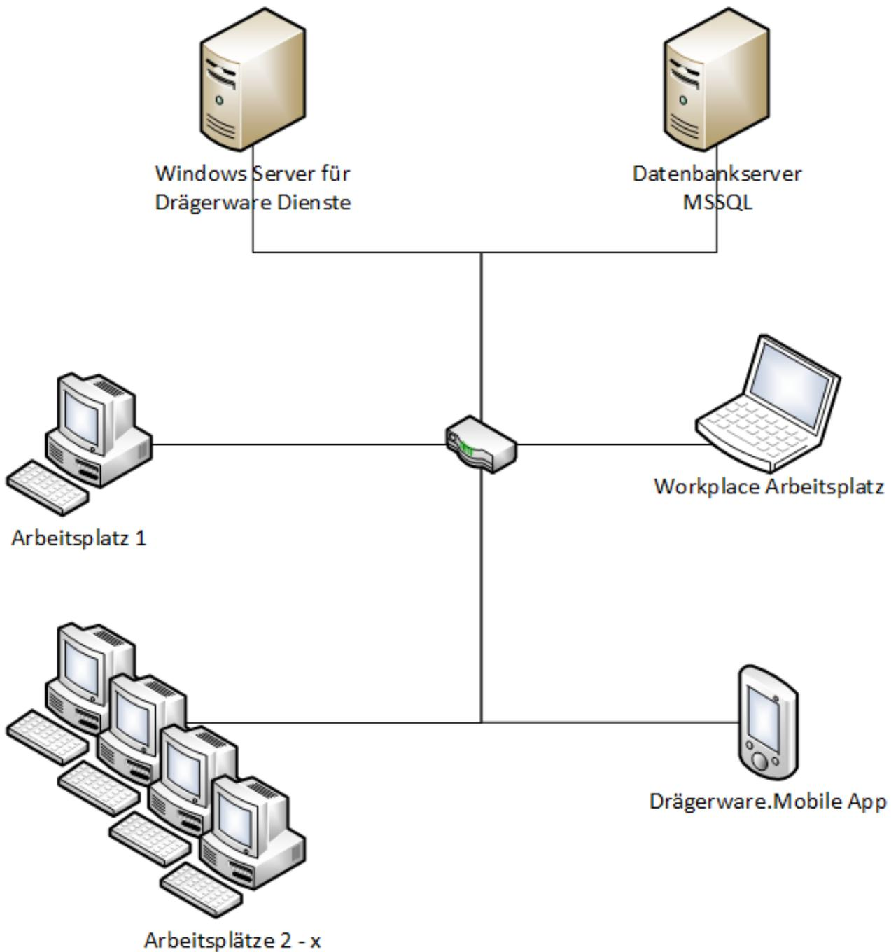
Die Arbeitsplätze (1 - x) greifen über eine LAN-Verbindung auf die jeweiligen Server zu. Workplace und die Drägerware.Mobile App können auch via WLAN angebunden sein.
