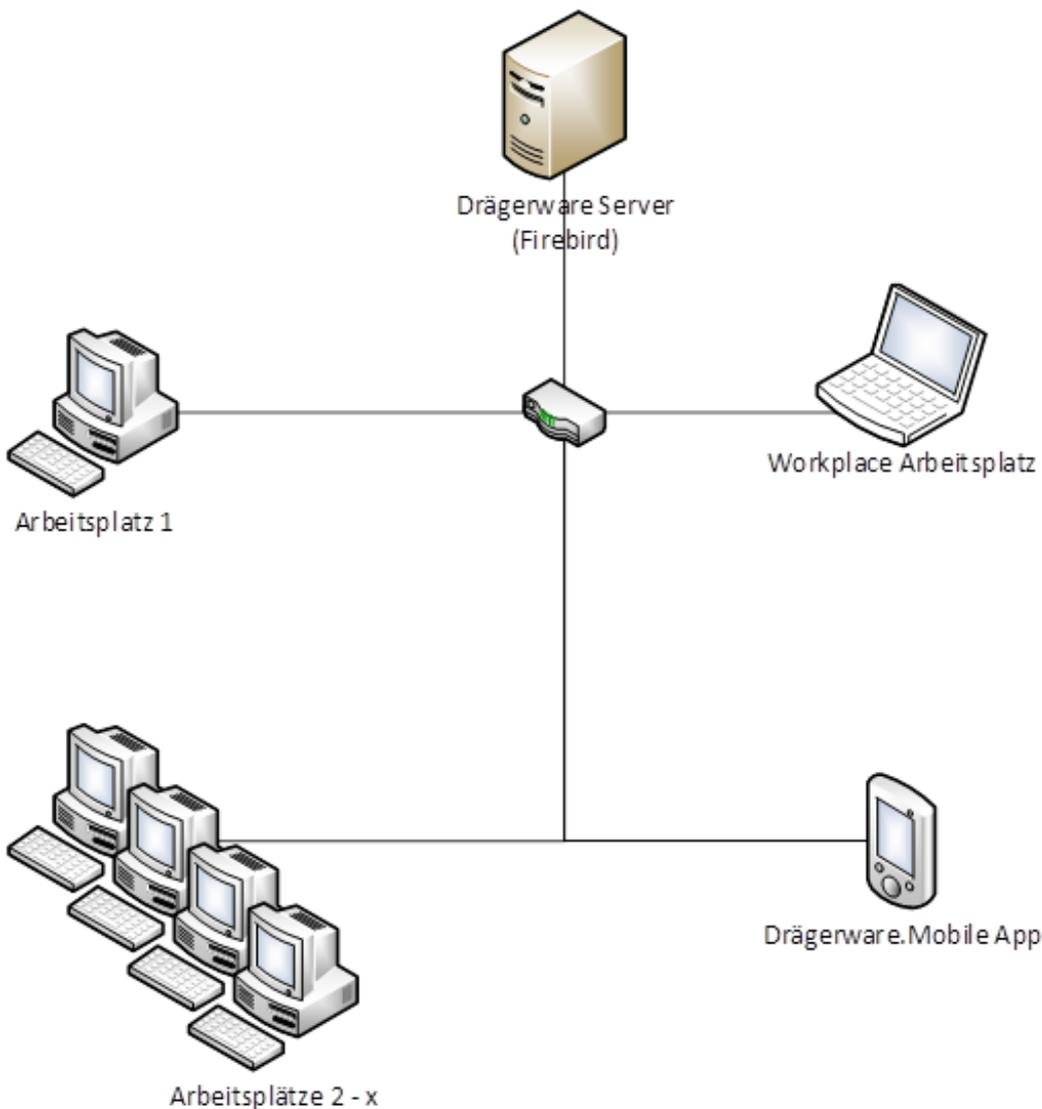
Die Arbeitsplätze (1 - x) greifen über eine LAN-Verbindung auf den Server zu. Workplace und die Drägerware.Mobile App können auch via WLAN angebunden sein.
